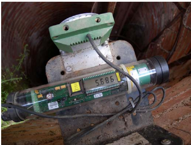
Figura 14. Dispositivo de lectura del limnígrafo de boya tipo Thalimedes de OTT instalado en la Finca "La Isla"
